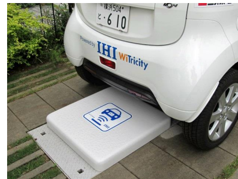
3.3kW 非接触給電システム (磁界共鳴方式)
